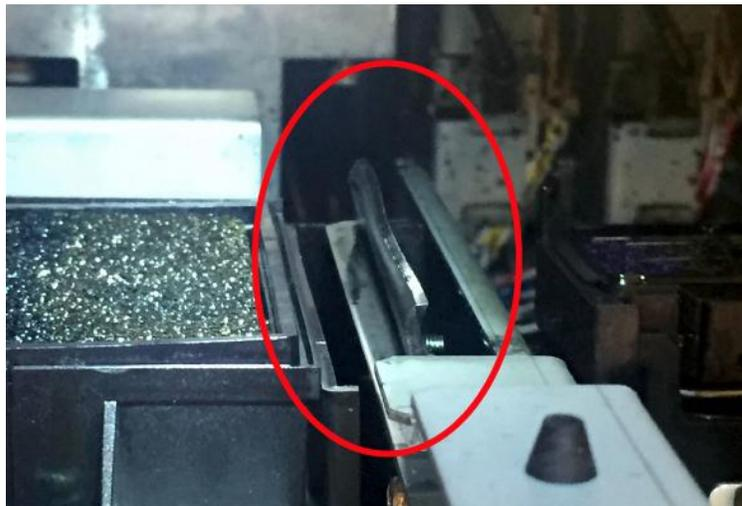
Encha o conta-gotas (pipeta) com Flush e esvazie 2 conta-gotas cheios no Wiper Blade e no balde embaixo. Isso dissolverá e removerá a tinta seca no coletor e no tubo de plástico sob a Estação Wiper e ajudará a evitar entupimentos e vazamentos de tinta.
